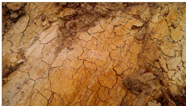
Obr. 9.15: Odlučná hrana zosuvu v Kraľovanoch a detail šmykovej plochy (foto: V. Jánová)
