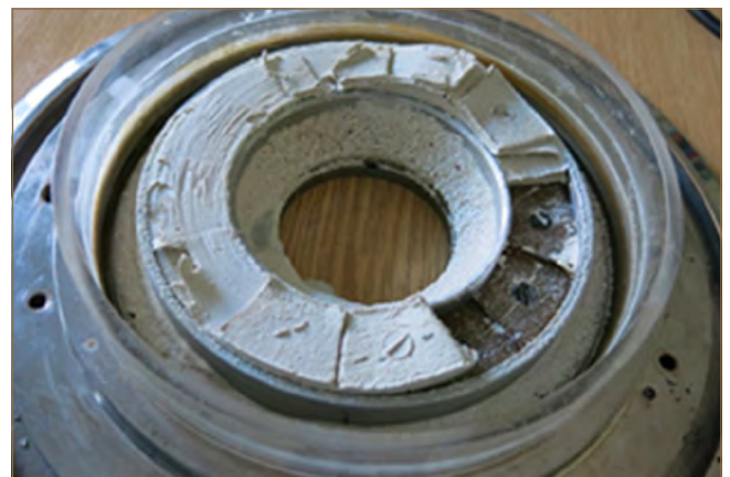
Obr. 9.29: Vzorka zeminy zo šmykovej plochy v krabicovom a kruhovom šmykovom prístroji po ukončení skúšky (foto: M. Kopecký)
