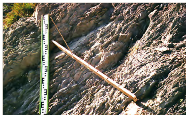
Obr. 3.15: Meranie pomocou merača mikromorfologických zmien povrchu terénu (foto: V. Jánová)
