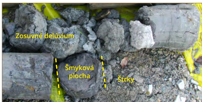
Obr. 9.22: Zachytená šmyková plocha vo vrtnom jadre na kontakte ílovitých delúvií a štrkov aluviálnej nivy – Vrt V-2 (Kopecký, 2010)
