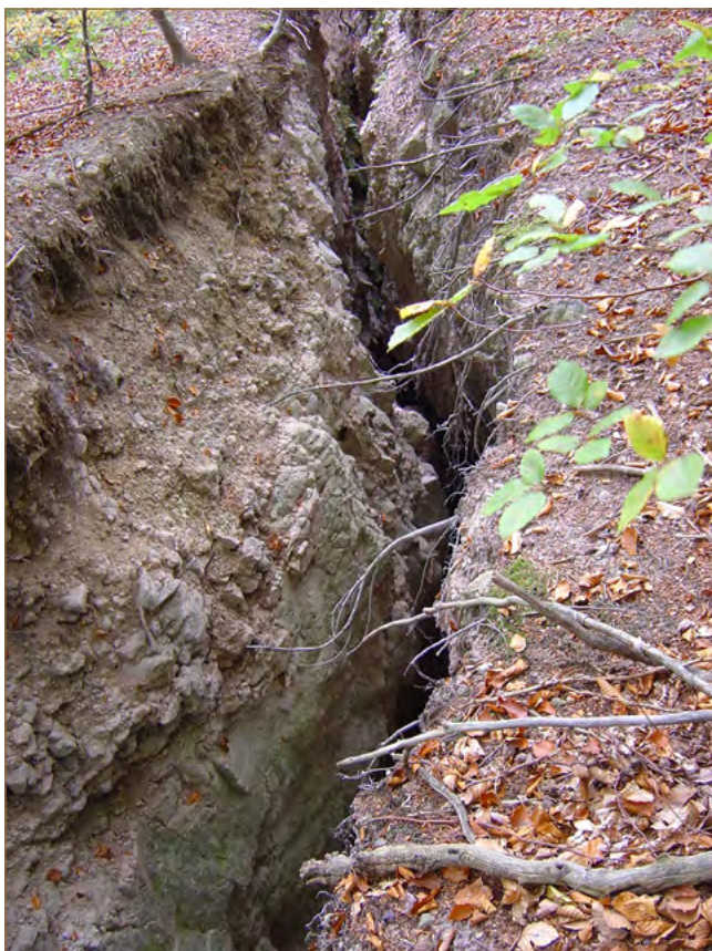
Obr. 3.26: Prejavom podrúbania pri ťažbe uhlia sú hlboké trhliny porušujúce svahy pohoria Vtáčnik východne od obce Cigelf (foto: V. Jánová)
