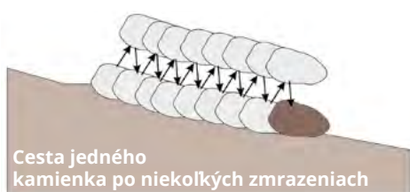
Obr. 4.5: Princíp pohybu častíc po svahu pri povrchovom plazení (vľavo), schéma povrchového plazenia (zliezanie svahových hĺn a sutín) (vpravo dole) (podľa Hamblin, 1991 upravila A. Mosná)
