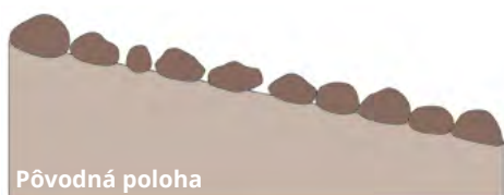
Obr. 4.4: Schéma vzniku blokových rozpadlín (vľavo), ukážka trhlín medzi blokmi andezitov vo Vtáčniku (vpravo hore) a LiDAR-ová snímka svahovej deformácie na Bielom kameni vo Vtáčniku (schéma A. Mosná, foto: V. Jánová, snímka zdroj: zbgis.skgeodesy.sk)
