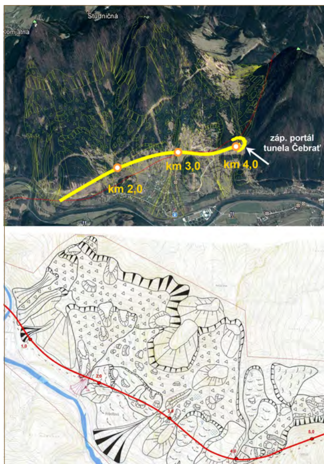
Obr. 3.8: Zosuvné územie na trase D1 – úsek Hubová – Ivachnová v km 2,0 – 4,0, ktoré vzniklo eróznou činnosťou Váhu (Kopecký a kol., 2018)
